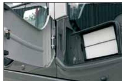
Le larghe porte consentono di accedere, da terra, al filtro del carburante, al separatore dell'acqua e al filtro dell'olio motore. Un comodo corrimano, dei gradini e le piastre antisdrucchiole conducono al cofano del motore. La coppa dell'olio motore è provvista di un attacco per lo spurgo: per eseguire lo spurgo all'attacco viene collegato un flessibile di drenaggio. Il tappo per lo spurgo è affidabile ed evita perdite di olio e atti vandalici.
