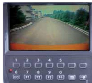
Il monitor LCD a colori widescreen, insieme alla videocamera di retrovisione sul contrappeso, fornisce una visuale dell'area posteriore.
