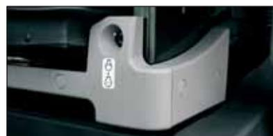
Leva di esclusione circuito di pilotaggio
