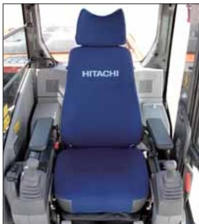
Sono inclusi i braccioli larghi regolabili e la cintura di sicurezza retrattile. La corsa breve delle leve consente di svolgere operazioni protratte con un minore affaticamento. Tre interruttori opzionali possono essere montati sulla leva per azionare gli accessori (tranne le benne). La cabina è pressurizzata per impedire l'ingresso della polvere. Rumore e vibrazioni sono ridotti al minimo grazie ai supporti elastici, riempiti di olio silicico, su cui poggia la cabina.
