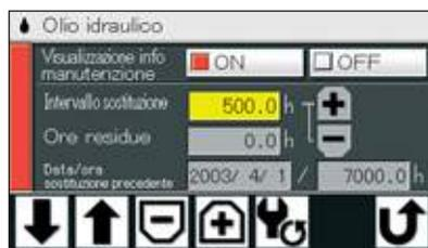
Ogni volta che si ruota la chiave di accensione, sul monitor LCD viene indicato l'intervallo per il ricambio dei filtri carburante e dell'olio idraulico, in base al programma preimpostato dall'utente. La manutenzione programmata contribuisce a evitare guasti.
