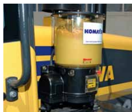
Impianto di lubrificazione automatica
