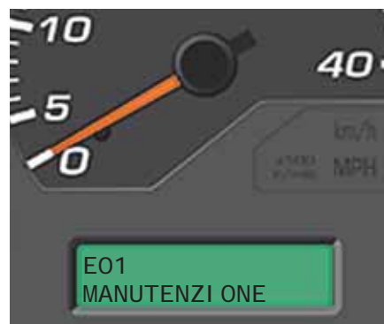
Sistema di monitoraggio e diagnostico EMMS
