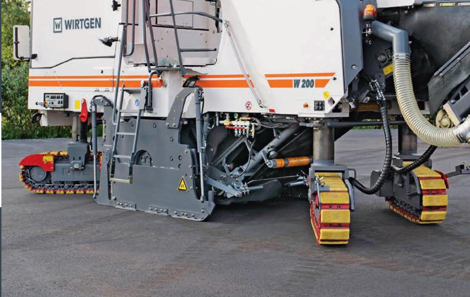
Con una larghezza operativa di 2,0 m è possibile un raggio di sterzata interno di 2.150 mm.
